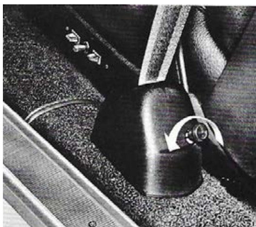
DE OPROLAUTOMAAT VAN DE HEUPGORDEL WAS VOORZIEN VAN EEN ONTGRENDEL PEN OM DE BLOKKERING OP TE HEFFEN OM NAAR VOREN TE KUNNEN BEWEGEN ZONDER DE GORDEL LOS TE MAKEN
