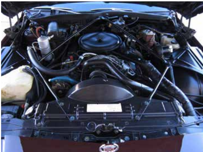
Het motor compartiment is aardig vol. De binnenschermen zijn van plastic
