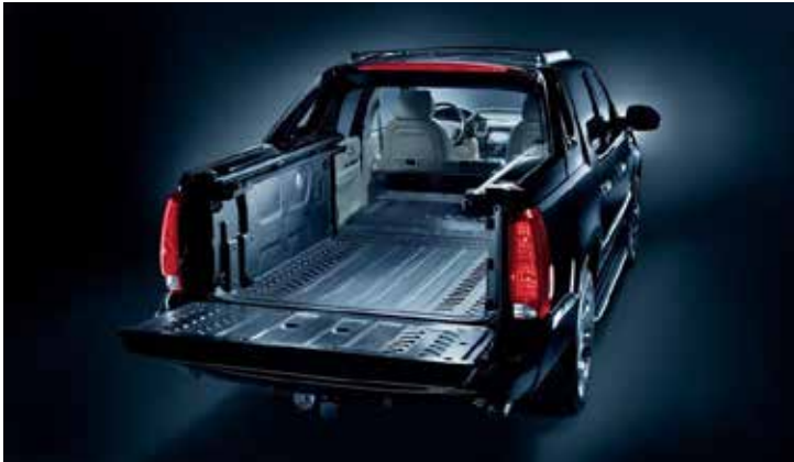
MET OPGEKLAPTE ACHTERBANKEN EN TUSSENSCHOT WORDT DE LAADVLOER VAN DE EXT VERLENGD, IN DE ZIJKANTEN VAN DE LAADBAK ZITTEN OPBERGRUIMTES
