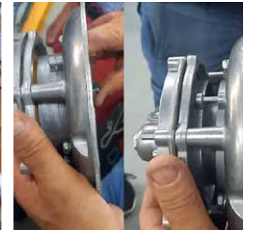
Impco mixer links gesloten rechts open
