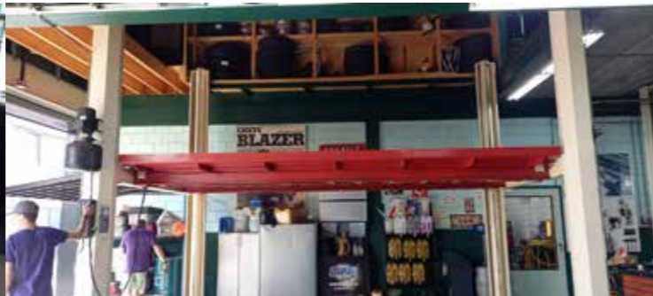
Met deze brug worden de auto's op de etage gezet
