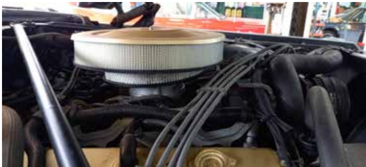
Een groot luchtfilter geplaatst boven het kleine van de Impco
