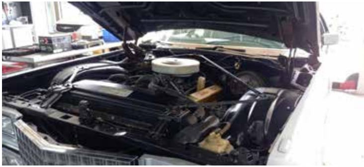
1976 Fleetwood van Wiljam met een groot luchtfilter boven het kleine Impco filter
