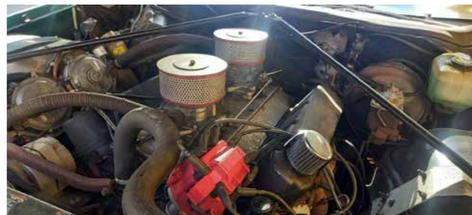
1973 Sedan de Ville van Ruud Mors, voorzien van twee gasconverters met dubbele carburateur en een speciaal inlaatspruitstuk
